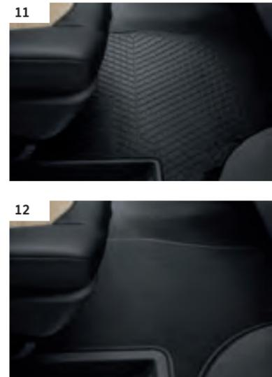
**11 Tapis de sol en caoutchouc.** Ils protègent le sol de l'habitacle contre l'humidité et garantissent sa propreté. Ils peuvent facilement être retirés pour un lavage à l'eau. | TL | CA | CE |
