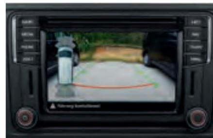
**Caméra de recul « Rear View ».** La caméra de recul « Rear View » facilite les manœuvres de stationnement en représentant la zone située à l'arrière du véhicule sur l'écran de la radio<sup>3)</sup> ou du système de navigation. Des lignes de guidage fixes viennent également aider au stationnement. | TL | CA | CE |
