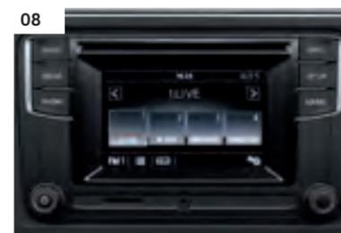
**08 Système de radio « Composition Colour ».** Ce système comprend un écran tactile couleur TFT de 12,7 cm (5"), un lecteur CD compatible MP3/WMA, six haut-parleurs d'une puissance de 4 x 20 watts, un lecteur de cartes SD, des interfaces AUX-IN et USB compatible iPhone, une fonction Bluetooth pour téléphones mobiles, ainsi qu'un double tuner pour une qualité de réception optimale. | TL |
