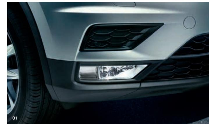
01 Les **projecteurs antibrouillard avec feux de braquage statiques** assurent l'éclairage de votre trajectoire. Lorsque vous braquez les roues ou que vous activez les clignotants, l'éclairage est automatiquement adapté à la situation dans les intersections et fonctionne jusqu'à 40 km/h.
