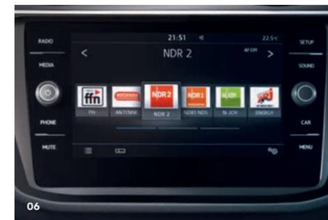
**06** Le système «Composition Media» est doté d'un écran couleur TFT tactile avec détecteurs d'approche de 20,3 cm (8 pouces) et d'un lecteur CD pouvant lire les fichiers MP3 et WMA. Les huit haut-parleurs, d'une puissance en sortie de 4 x 20 watts, vous offrent une expérience multimédia complète. Il est également pourvu d'un logement pour carte SD, d'une prise AUX-IN, d'une interface USB et d'une connexion Bluetooth® pour téléphones portables.
