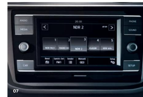
**07** Le système «Composition Colour» est équipé d'un écran tactile TFT couleur de 16,5 cm (6,5 pouces) et de huit haut-parleurs pour une puissance en sortie de 4 x 20 watts, ainsi que l'un logement pour carte SD.
