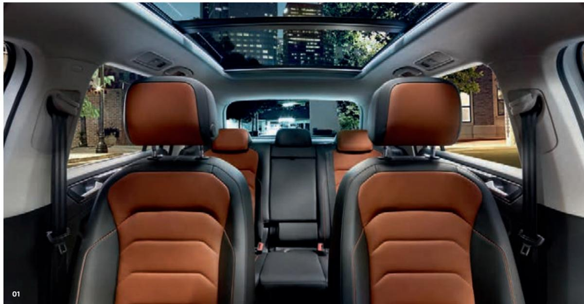
**01** Le système de sièges modulables permet de rabattre le dossier de tous les sièges passagers. De plus, la banquette arrière asymétrique peut être déplacée dans le sens longitudinal. De série dès Confortline.
