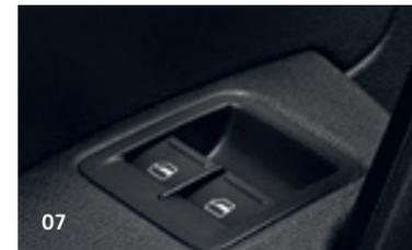
**07 Lève-vitres électriques.** Les commandes situées dans les accoudoirs des portes sont facilement accessibles. Elles sont équipées d'un dispositif anti-pincement. | CC | TL | CL | AL |
