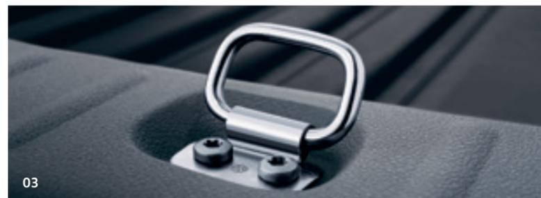
**03 Œillets d'arrimage.** Pour sécuriser le chargement, quatre œillets d'arrimage sont prévus dans le coffre du Caddy et six dans le Caddy Maxi. Si vous choisissez le Caddy à empattement court avec la troisième rangée de sièges en option, vous ne disposerez que de deux œillets d'arrimage dans le coffre. | CC | TL | CL | AL |
