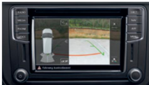
**Caméra de recul « Rear View ».** La caméra assiste le conducteur pendant les manœuvres de stationnement. L'image affichée sur l'écran de la radio ou du système de navigation montre la zone située à l'arrière du véhicule.<sup>2)</sup> La trajectoire est représentée à l'aide de lignes de guidage sur l'écran.<sup>3)</sup> La caméra de recul est uniquement utilisable en combinaison avec le hayon.
