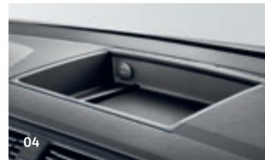
**04 Prise 12 V.** Intégrée dans le compartiment de rangement ouvert de la console centrale, elle permet de brancher des appareils mobiles, tels que les téléphones portables ou les notebooks. | CC | TL | CL | AL |
