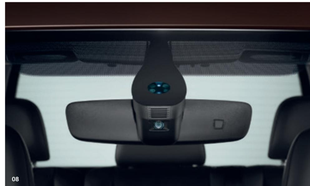
**08 Pack Visibilité.** Le rétroviseur intérieur s'assombrit automatiquement pour que vous ne soyez pas ébloui par les projecteurs du véhicule qui vous suit. Un capteur placé dans le support du rétroviseur allume automatiquement les projecteurs lorsqu'il fait sombre. Lorsqu'il commence à pleuvoir, il active les essuie-glaces et adapte leur vitesse à l'intensité de la pluie. Ce pack comprend également la fonction « Coming home / Leaving home ». <sup>2)</sup> | TL | CL | AL |
